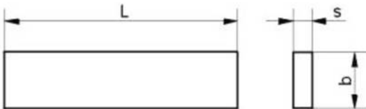
Рисунок 23 - Образцы материалов для испытания на трехточечный изгиб
