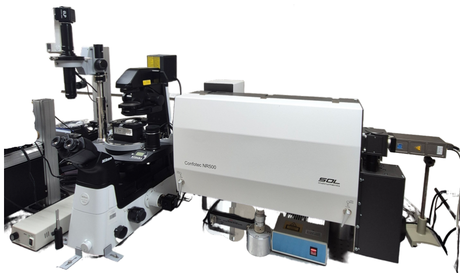
Рисунок 7 - Конфокальный спектрометр «Confotec NR500» (SOL Instruments, Беларусь)
