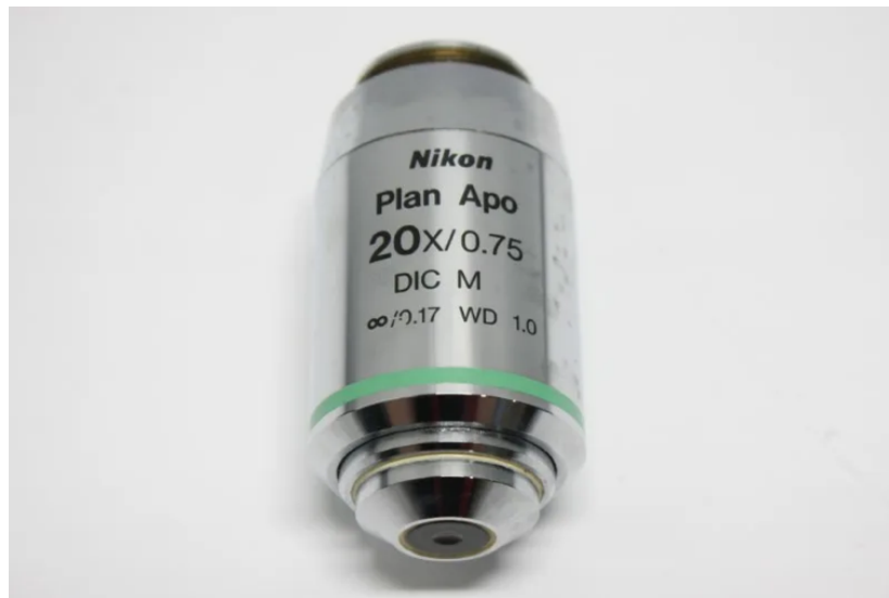
Рисунок 8 - Объектив «Plan Apo» (Nikon Corporation, Япония)
