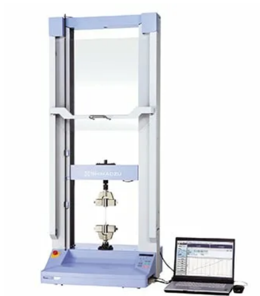
Рисунок 58 - Универсальная испытательная машина «Shimadzu AG-Xplus-0.5» (Shimadzu, Япония)
