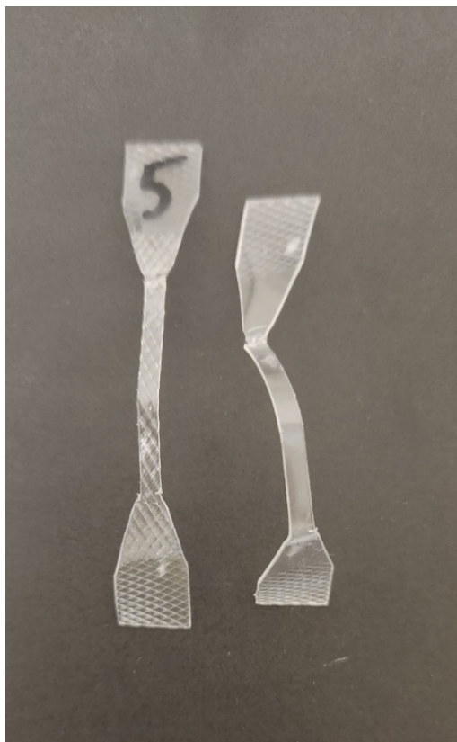
Рисунок 62 - Образцы материала «Zendura» после испытаний на растяжение
